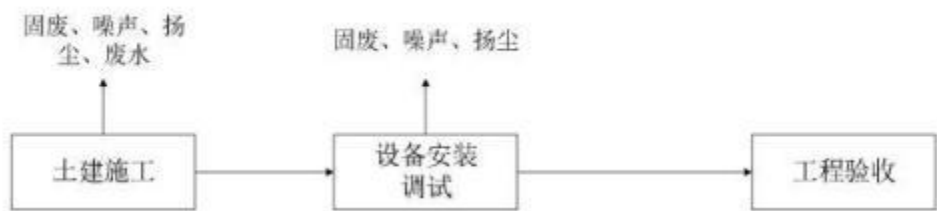
图 2-1 本项目工艺流程及产排污节点示意图
